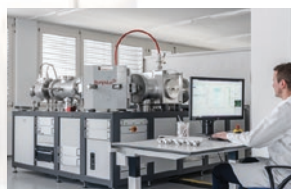
MICADAS Mini Carbon Dating System
