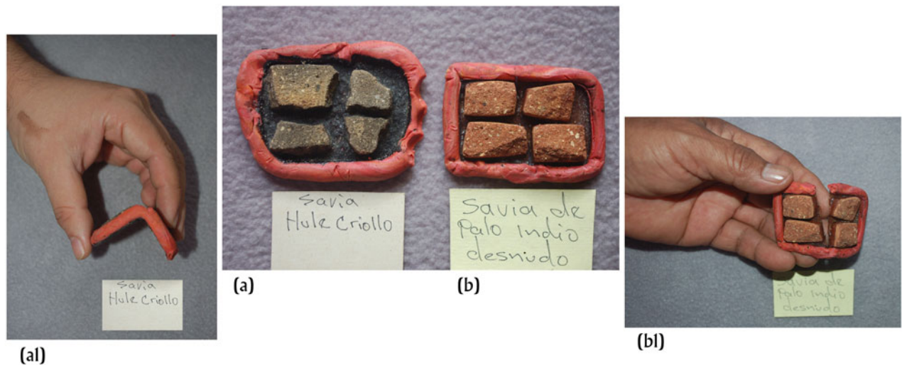
Figura 5. Ensayo de arqueología experimental para probar los adhesivos: (a y a1) teselas de cerámica insertadas en lienzo de hule (flexible; Castilla elástica ) vulcanizado con liana Flor de Luna ( Ipomoea alba ). (b y b1) Teselas de cerámica adheridas sobre lienzo de adhesivo de resina (no flexible) del árbol local Palo Jiote ( Bursera simaruba ). Fotografías: Parque Arqueológico Nacional Tak'alik Ab'aj, MICUDE-DGPCYN/IDAEH.
