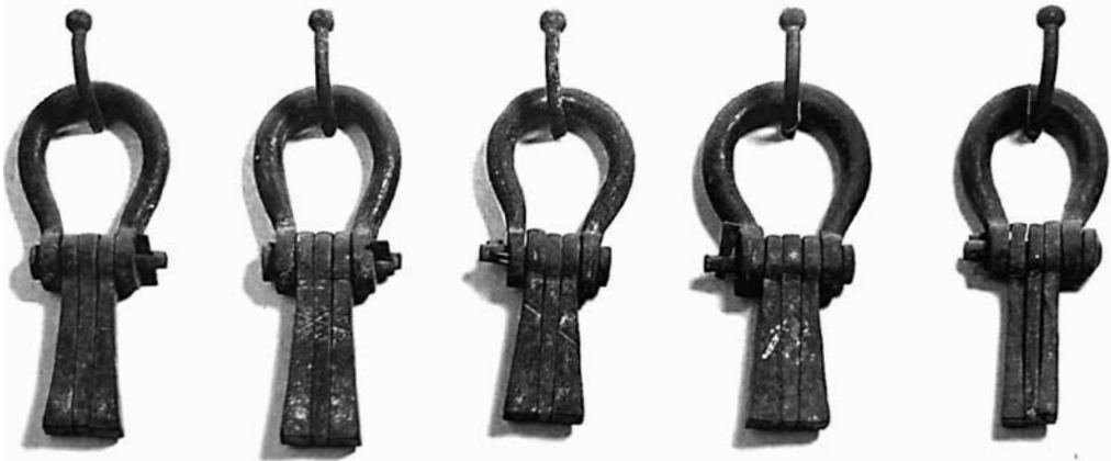
Fig. 1. Lewis irons in the collections of the Museo dell'Opera del Duomo, Florence
