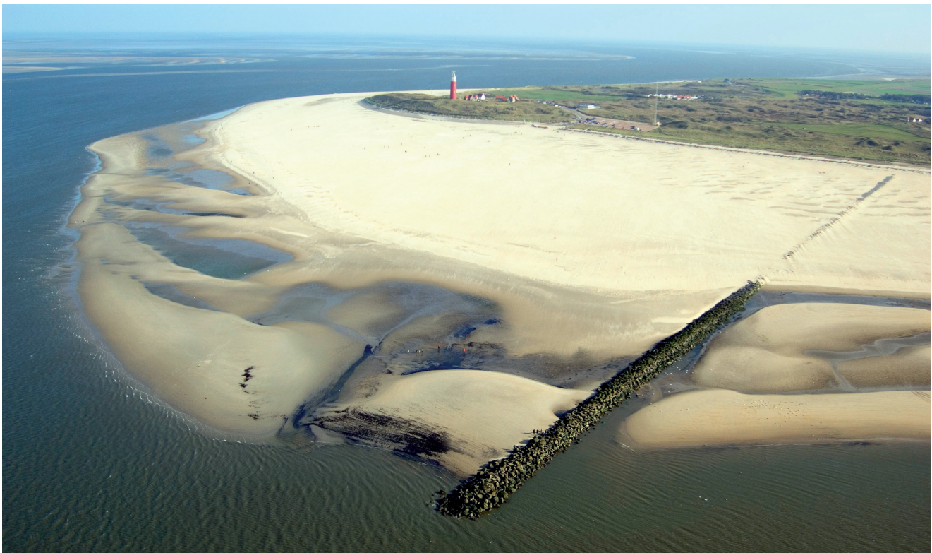
Fig. 9. Accretion around the Eierlandse Gat dam in 2005 (source: https://beeldbank.rws.nl , Rijkswaterstaat).
